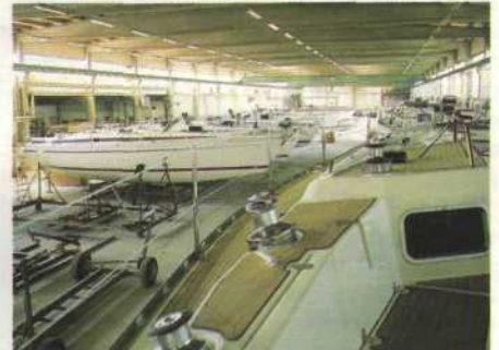
Afbouwhal. Alle schepen staan op verrijdbare bokken voor het interne transport.
