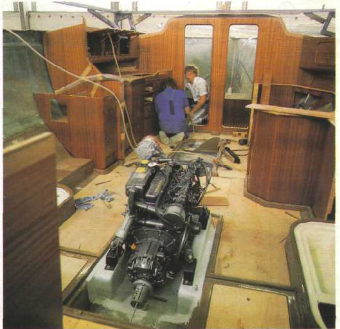
In het vormstuk dat een geheel vormt met het vlak, zitten uitsparingen waarin de betimmering past. Achter de motor zijn op deze foto een paar wrangen te zien met het zwart gekleurde koolstofvezel.
