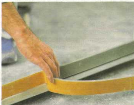
In tegenstelling tot de meeste andere werfven lijmt Bavaria het dek niet aan de romp, maar bevestigt het dek met bouten en moeren tegelijk met de voetrail. Deze band zorgt voor een volledig waterdichte afsluiting tussen romp en dek. GL wijst het lamineren van dek aan romp af, omdat deze maatschappij meent dat het lamineren in een dicht schip niet goed kan gebeuren.
