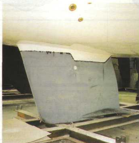
De kiel hangt aan een massief polyester deel met een speciale vorm. Dit polyester deel vormt een geheel met het vlak en de wrangen. Door deze vorm zal bij aan de grond lopen de achterkant van de kiel niet door het vlak drukken. De zwarte kit zorgt voor een waterdichte afsluiting tussen het gietijzer van de kiel en het polyester.
