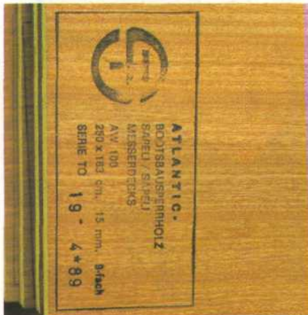
Tussen multiplex en multiplex bestaan grote verschillen, omdat Bavaria onder GL bouwt, mag de werf alleen multiplex gebruiken dat voldoet aan de eisen van deze maatschappij. Op iedere plaat multiplex staat dit stempel met AW 100, dat de kwaliteit van de plaat aangeeft.
