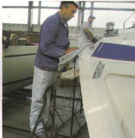
Monteren van het dek, de romp en de voetrail met de speciale band.
